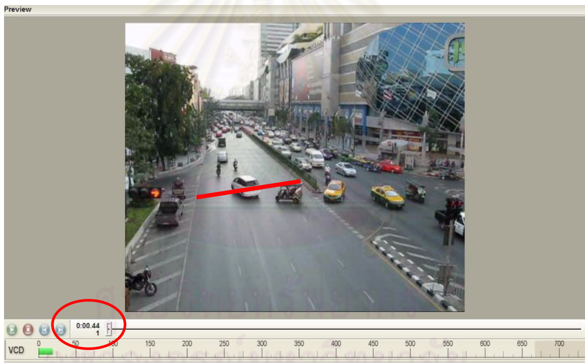
ภาพที่ 3.1 การหาเวลาที่รถผ่านเส้นอ้างอิง
