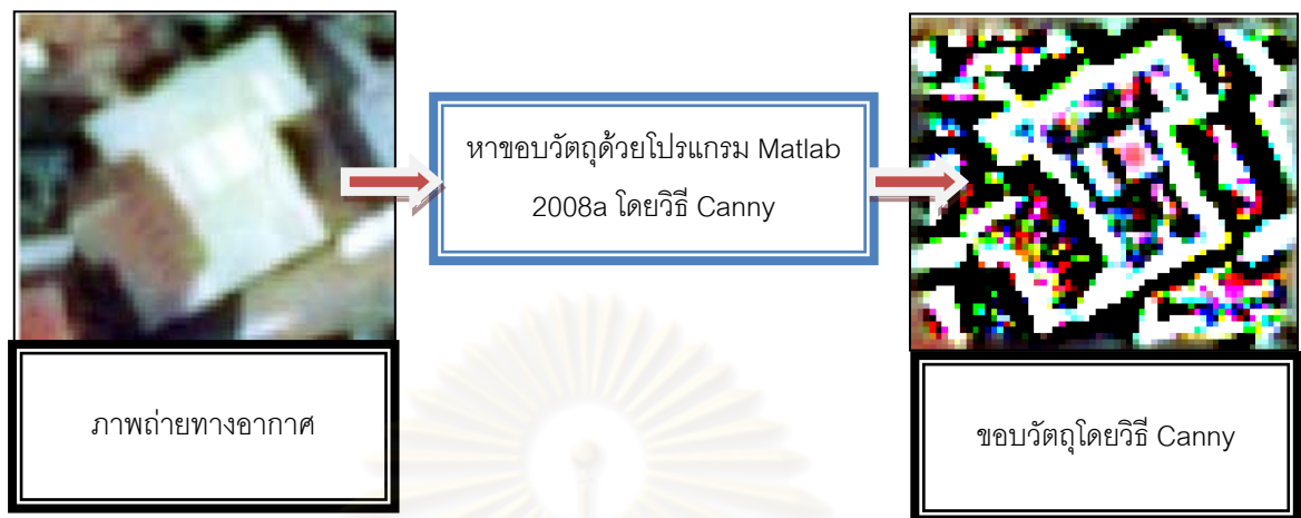
รูปที่ 3.13 ภาพถ่ายทางอากาศที่ทำการหาขอบวัตถุโดยวิธี Canny
