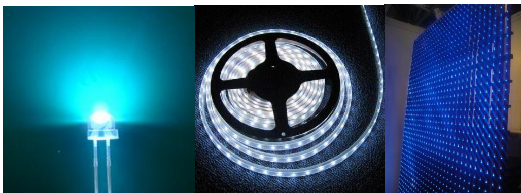
รูปที่ 2-40 แสดงแหล่งกำเนิดแสงแบบจุด แบบเส้น และแบบระนาบ จากซ้ายไปขวาตามลำดับ ที่มา : 21Ledonline ,2555 : ออนไลน์
