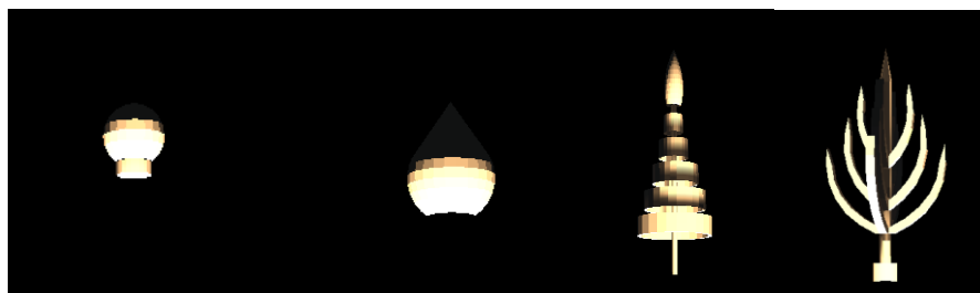
รูปที่ 7-1 แสดงลักษณะแสงเงาที่เกิดในการติดตั้งดวงโคมแบบ uplight ส่องที่ส่วนยอดพระเจดีย์
