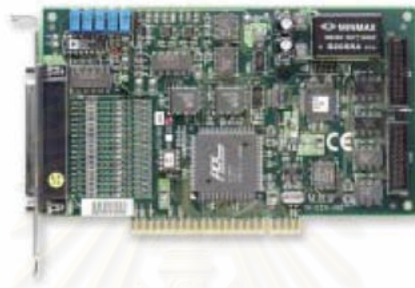
รูปที่ ก.1 การ์ดเก็บข้อมูลจาก Adlink รุ่น PCI-9111DG
