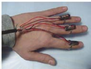
รูปที่ 2.5 การให้ข้อมูลด้วยแรงสั่นสะเทือนของมอเตอร์กระแสตรง[8]
