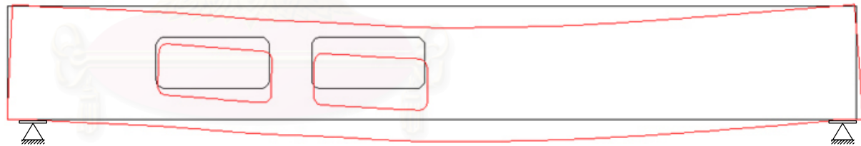
รูปที่ 4.4.4 ผลการวิเคราะห์หน่วยแรงและระยะการเคลื่อนที่ในโครงขายที่ 5
