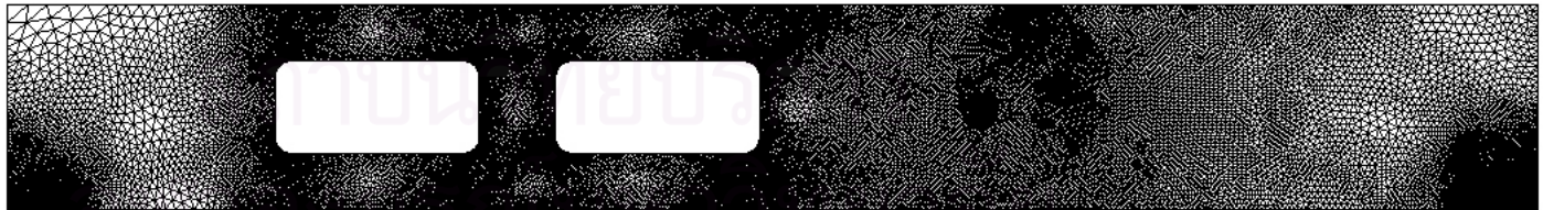
รูปที่ 4.4.2 โครงข่ายที่ปรับตามเหลี่ยมในปัญหาความถี่เดียวที่มีช่องเปิด (กำหนดค่าลดขนาดเหลี่ยมให้ 0.05)
