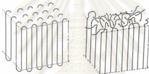
รูปที่ 2.6 แสดงแบบจำลองโครงสร้าง Folded chain crystalline ที่รูปผลึกเป็นลามลลา
