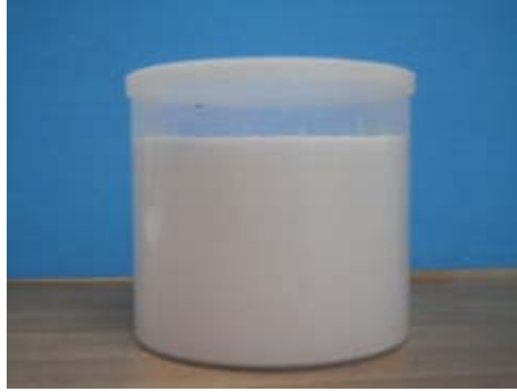
รูปที่ 3.8 ต้นกำเนิดรังสีแกมมาแบบภาชนะ Marinelli beaker
