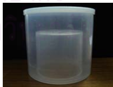
รูปที่ 3.4 ภาชนะ Marinelli beaker ขนาด 0.5 ลิตร
