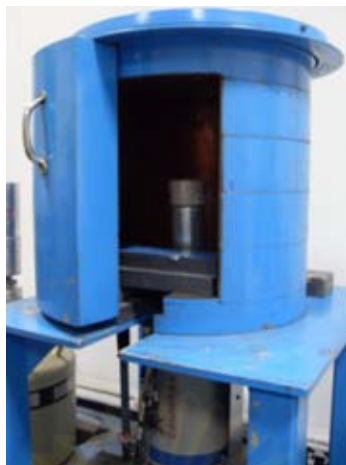
รูปที่ 3.1 ระบบการวัดรังสีแกมมาของบริษัท Canberra
