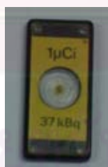
รูปที่ 3.5 ต้นกำเนิดรังสีแกมมาซีเซียม-137 แบบจุด
