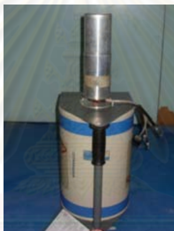
รูปที่ 3.2 หัววัดรังสี HPGe ของบริษัท Canberra
