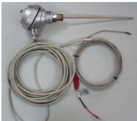
ภาพที่ 5.6 เอร์โมคัปเปิลชนิด K และ RTD ชนิด PT100
