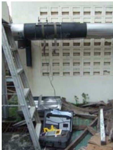
ภาพที่ 5.14 ตำแหน่งที่ติดตั้งเครื่อง Ultrasonic flow meter
