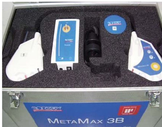
รูปที่ 8 อุปกรณ์ประมวลผลการวิเคราะห์การแลกเปลี่ยนก๊าซ
