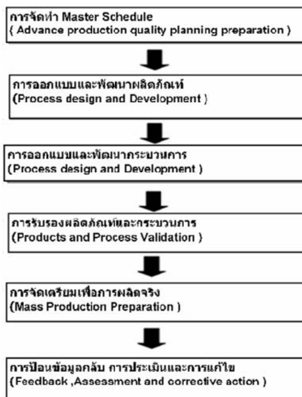
ภาพที่ 3.5 กระบวนการรับรองคุณภาพชิ้นส่วนใหม่ของผู้ประกอบการ ตามกระบวนการวางแผนคุณภาพผลิตภัณฑ์ล่วงหน้า
