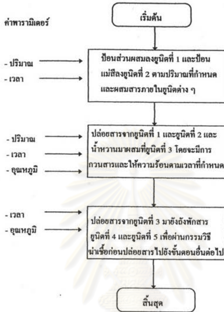
รูปที่ 5.1 ขั้นตอนการผลิตของระบบตัวอย่างที่ใช้ทดสอบระบบ
