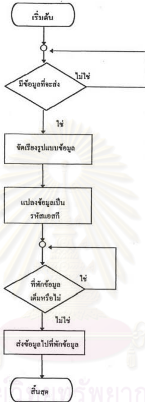
รูปที่ 4.23 โฟลว์ชาร์ตขั้นตอนโปรแกรมการส่งข้อมูล
