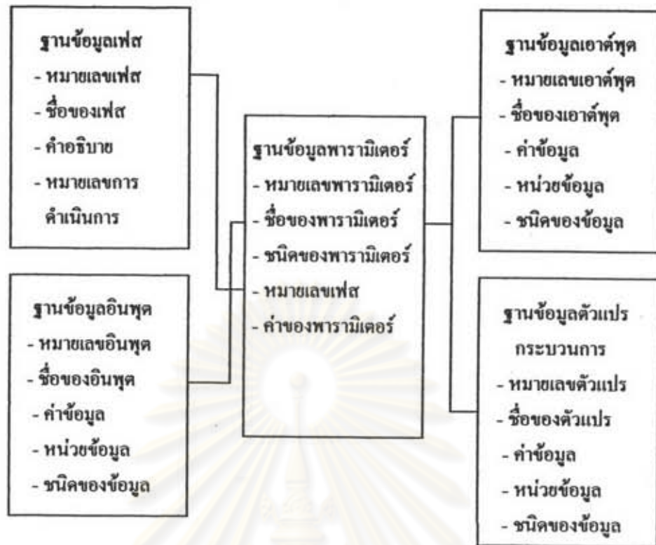
รูปที่ 4.19 การเชื่อมโยงข้อมูลของฐานข้อมูลพัสดุ ฐานข้อมูลใบพิกัด ฐานข้อมูลเอาต์พิกัด และฐานข้อมูลตัวแปรกระบวนการ
