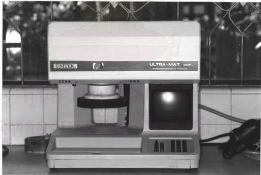
รูปที่ 28 แสดงเตาเผาพอร์ซเลน ยี่ห้อ ULTRA-M-A-CDF
