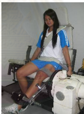
รูปภาพที่ 3.9 การทดสอบความแข็งแรงของกล้ามเนื้อแบบไอโซคิเนติก
