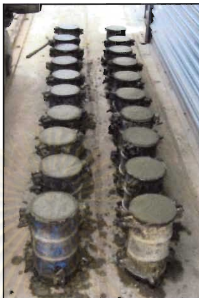
รูปที่ 3.4 แสดงการเก็บตัวอย่างคอนกรีตรูปทรงกระบอกที่ทดสอบกำลังอัด
