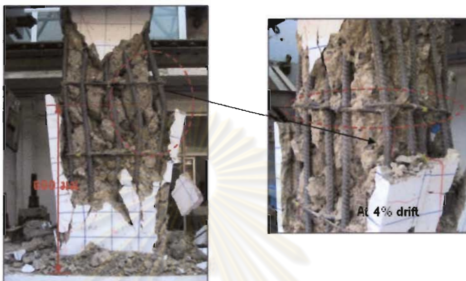
รูปที่ 4.2 รูปแบบการวิบัติของตัวอย่าง S1 หลังการทดสอบ
