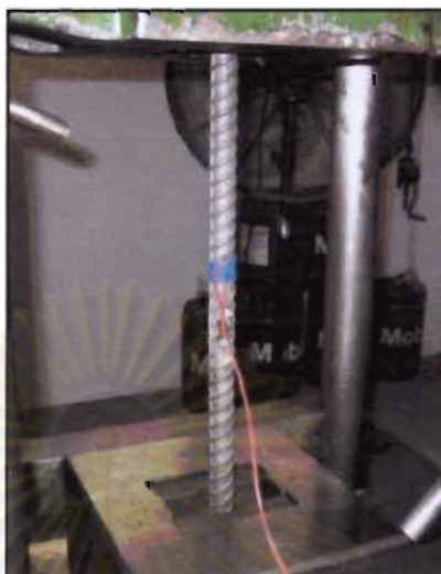
รูปที่ 3.5 แสดงตัวอย่างการทดสอบคุณสมบัติของเหล็กเสริม
