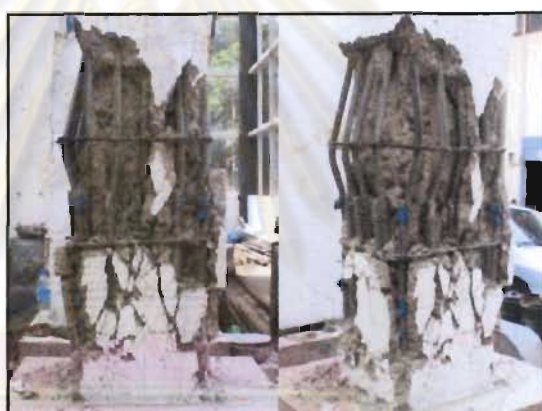
(ข) รูปการทดสอบหลังการวิบัติของเสาตัวอย่างทดสอบ S2s
