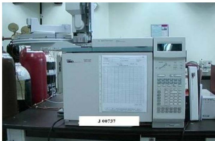
ภาพที่ 3.3 เครื่องแก๊สโครมาโทกราฟจำลองการกลั่น (simulated distillation gas chromatography: Varian CP-3800)
