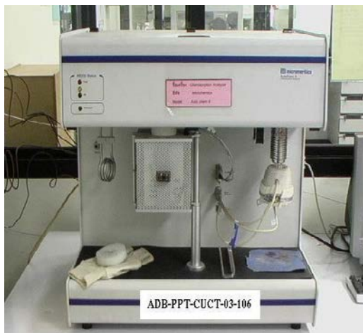
ภาพที่ 3.8 เครื่อง chemisorption analyzer รุ่น Micromeritics AutoChem II 2920
