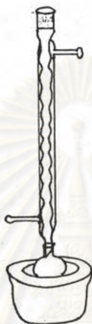
รูปที่ ก-2 อุปกรณ์ที่ใช้ reflux หาปริมาณเคอร์คูมิน
