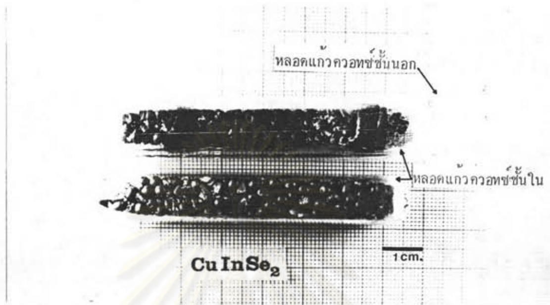
รูปที่ 9.6 แสดงหลอมแกวควอทซ์ที่บรรจุธาตุ Cu, In และ Se เรียบร้อยแล้ว
