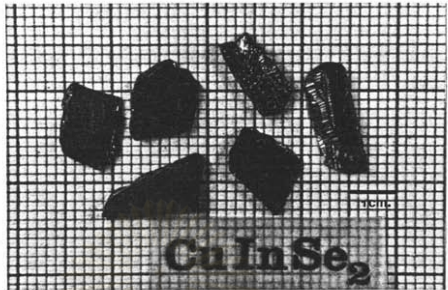
รูปที่ 9.10 แสดงชิ้นผลึกกึ่งตัวนำ \text{CuInSe}_2 ซึ่งเตรียมได้จากวิธีของ บริจแมน-สโตคบาร์เกอร์ที่ตัดเป็นชิ้นบาง ๆ และบางชิ้น ขัดด้วยกระดาษทรายละเอียด
