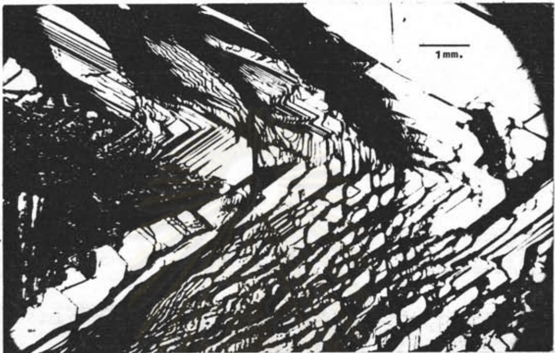
รูปที่ 9.8 แสดงผิวหน้าของผลึกกึ่งตัวนำ \text{CuInSe}_2 ที่เตรียมได้โดยวิธีของบริคแมน-สโตคบาร์เกอร์
