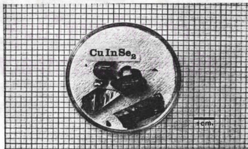
รูปที่ 9.7 แสดงขนาดของสารตัวอย่าง \text{CuInSe}_2 ที่เตรียมได้โดยวิธีของบริคจ์แมน-สโตคบาร์เกอร์
