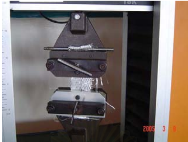
ภาพ ก.4 วิธีใส่ใยแก้วตัวอย่างสำหรับการทดสอบค่าความต้านทานแรงดึง
