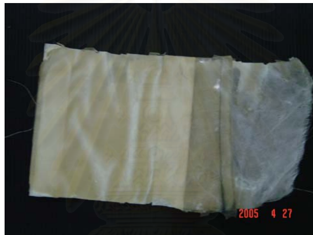
ภาพ ก.4 วิธีใส่ใยแก้วตัวอย่างสำหรับการทดสอบค่าความต้านทานแรงดึง
