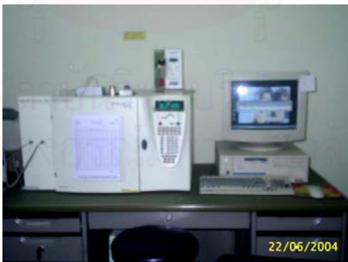
รูปที่ 3.9 เครื่อง Gas Chromatograph ยี่ห้อ Thermo Finnigan รุ่น TRACE GC
