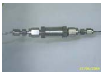
รูปที่ 3.5 Inline Filter
