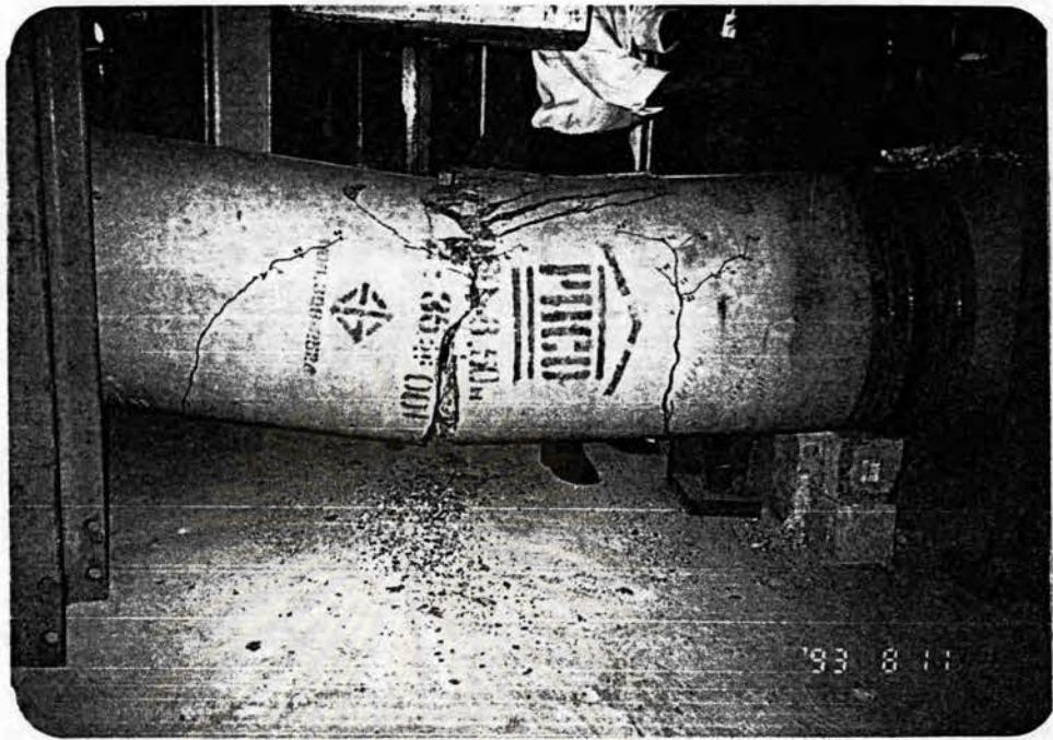
รูปที่ 3.11 แสดงการวิบัติของตัวอย่าง SPD-60
