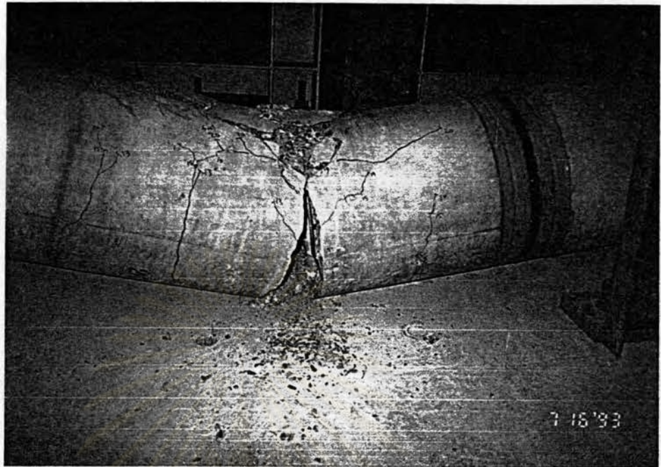
รูปที่ 3.9 แสดงการวิบัติของตัวอย่าง SPD-45
