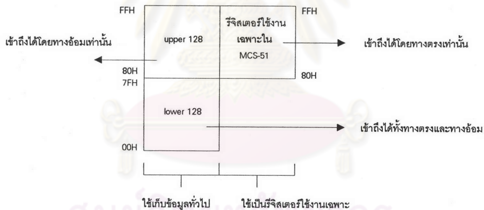
รูปที่ 2.22 หน่วยความจำสำหรับเก็บข้อมูลภายในชิป MCS-51
