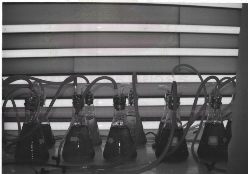
รูปที่ 6 ตู้เพาะเลี้ยงสาหร่ายเกลียวทอง ( Spirulina sp.)
