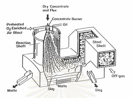
Figure 1.1 Outokumpu Flash Furnace (Davenport et al, Flash Smelting, 1984).
