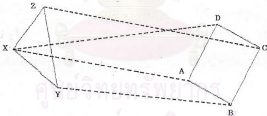
รูปที่ 3.18 แสดงความสัมพันธ์ของจุดระหว่างภาพหลัก 2 ภาพที่มีจำนวนจุดไม่เท่ากัน
