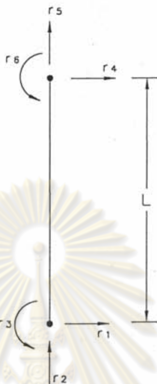
รูปที่ 2.17 ชิ้นส่วนเสาที่มีจุดหมุนพลาสติกเกิดที่ปลายด้านบน และด้านล่าง
