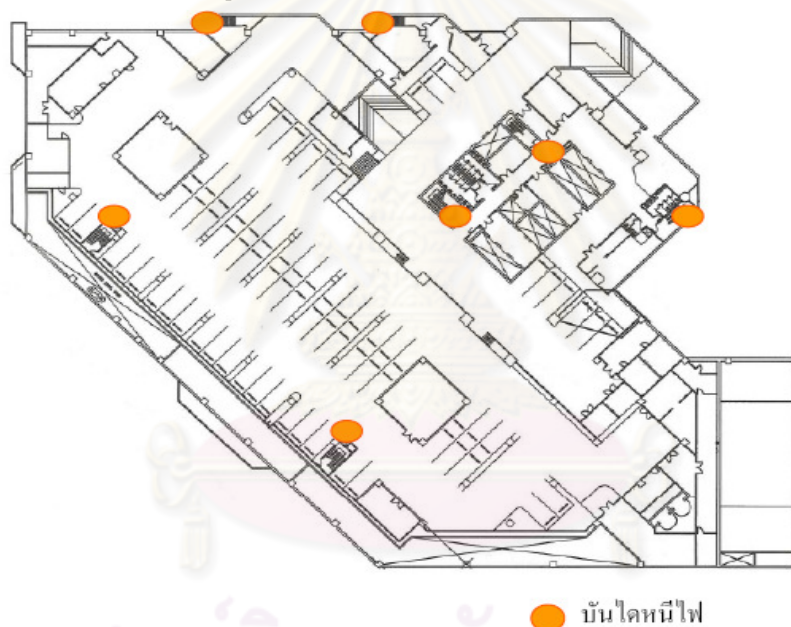
ภาพที่ 3.1 ทางหนีไฟของอาคารศูนย์การค้า A
