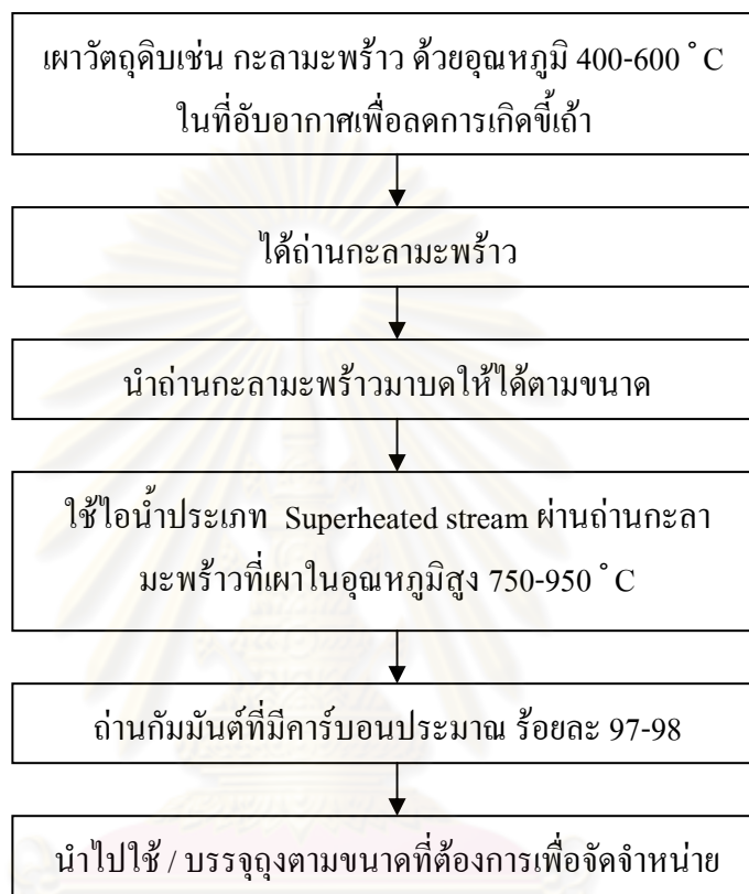
รูปที่ 2.12 ขั้นตอนการผลิตถ่านกัมมันต์ด้วยวิธีทางกายภาพโดยการกระตุ้นด้วยไอน้ำ
