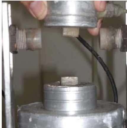
รูปที่ 3.8 เบนเดอริอิลิเมนต์ที่ติดตั้งในเครื่องสามแกน
