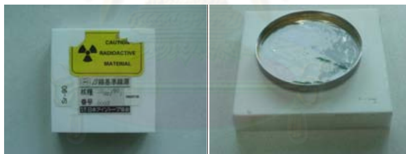
รูปที่ 3.10 ต้นกำเนิดรังสีบีตา ชนิด สทรอนเชียม - 90 จุฬาลงกรณ์มหาวิทยาลัย
