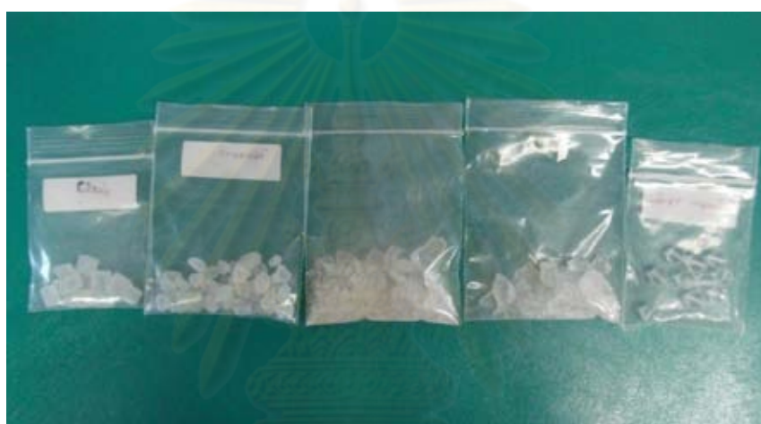
รูปที่ 3.12 ตัวอย่างโทแปส ที่ใช้ในการวิเคราะห์ NAA
