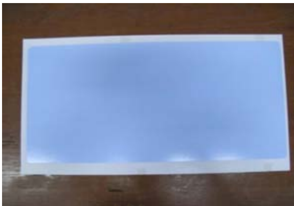
รูปที่ 3.3 แผ่นบันทึกภาพ (BAS-SR 2040) ผลิตโดยบริษัท ฟุจิฟิล์ม ขนาด 20 ซม. x 40 ซม.
