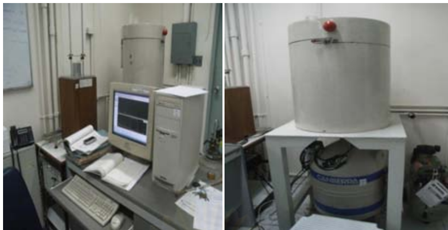
รูปที่ 3.14 หัววัดรังสี HPGe และเครื่องวิเคราะห์สัญญาณแบบหลายช่อง (MCA)
