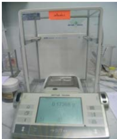
รูปที่ 3.17 เครื่องชั่งน้ำหนักมาตรฐานแบบละเอียด (ทศนิยม 4 ตำแหน่ง)
