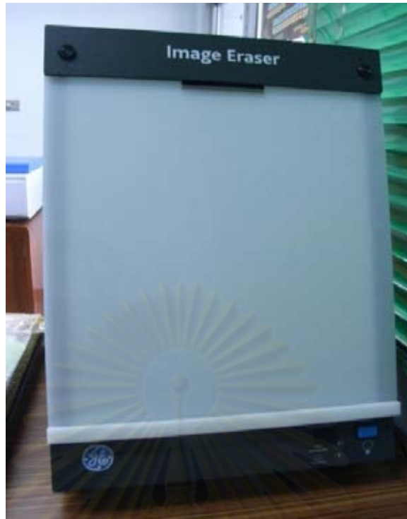
รูปที่ 3.5 เครื่องลบภาพ(Image Eraser) รุ่น 810-UNV ผลิตโดยบริษัท จีคิวเฮลแคร์ ไบโอไฮลด์ เอเชีย
