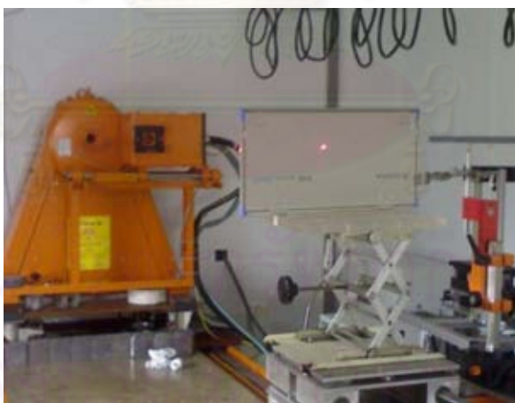
รูปที่ 3.23 การจัดวางแผ่นบันทึกภาพสำหรับเปรียบเทียบปริมาณรังสีจากต้นกำเนิดรังสี Co-60 และ Cs-137
