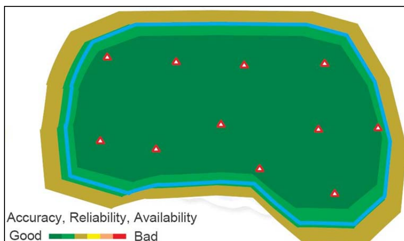
รูปที่ 1.2 แสดงความสัมพันธ์ระหว่างระยะทางของสถานีฐานถึงสถานีผู้ใช้งานกับค่าความถูกต้องทางตำแหน่ง ความน่าเชื่อถือของค่าพิกัดและพื้นที่ให้บริการของเทคนิคการรังวัดแบบจลน์ในทันที โดยอาศัยระบบเครือข่ายสถานีฐานจีพีเอส
