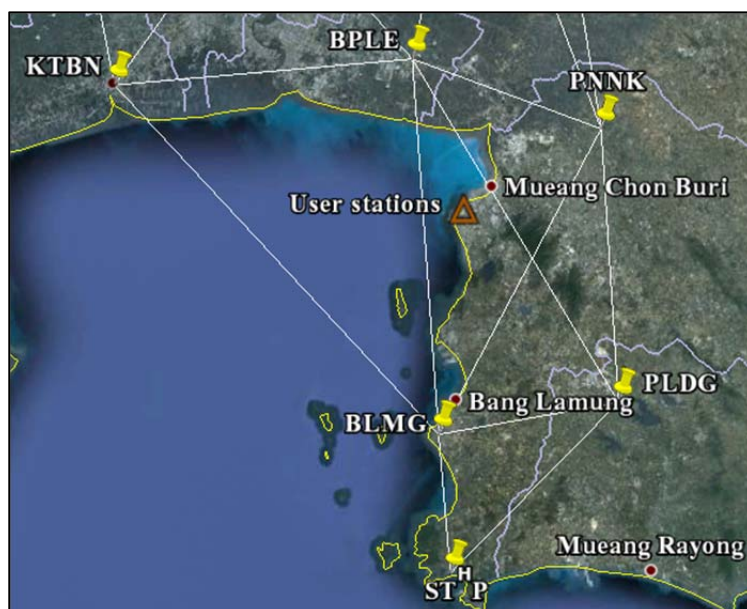
รูปที่ 4.2 แสดงตำแหน่งของสถานีผู้ใช้งานสำหรับการรังวัดด้วยดาวเทียมจีพีเอสแบบจลน์ในทันที โดยอาศัยระบบเครือข่ายสถานีฐานจีพีเอสแบบ VRS ในประเทศไทย
