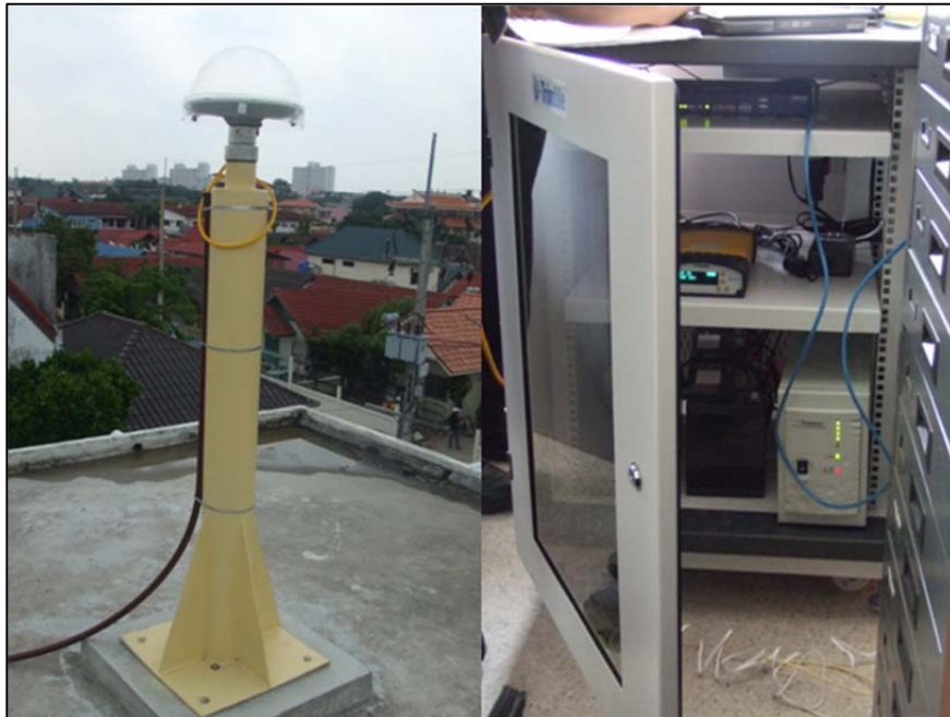
รูปที่ 2.9 แสดงตัวอย่างการติดตั้งสถานีฐานจีพีเอสถาวร (ซ้าย) แสดงเสาอากาศรับสัญญาณดาวเทียมแบบรับวง (ขวา) แสดงเครื่องรับสัญญาณดาวเทียมแบบรับวงและอุปกรณ์สื่อสารที่เชื่อมต่อกับระบบอินเทอร์เน็ต
