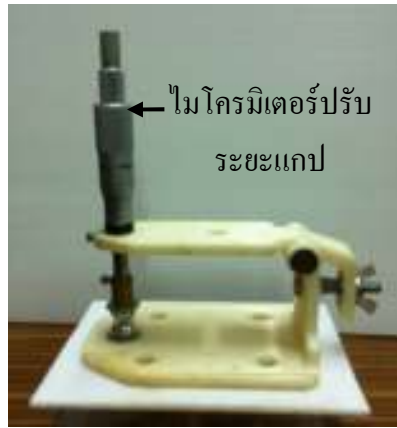
(ก) โครงสร้างของระบบ (ข) อิเล็กโตรดไฟฟ้าแรงสูงและอิเล็กโตรดกราวนด์
