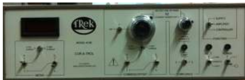
ภาพที่ 3.5 เครื่องขยายแรงดันไฟฟ้า
