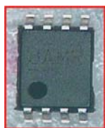
รูปที่ 1.3 แสดงไอซีประเภท VSOP (Very Small Outline Package)
