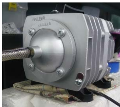
รูปที่ 3.3 เครื่องเติมอากาศ
