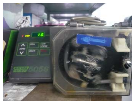
รูปที่ 3.2 เครื่องสูบน้ำ (ก) แบบไดอะแฟรม (ข) แบบปริดสาย
