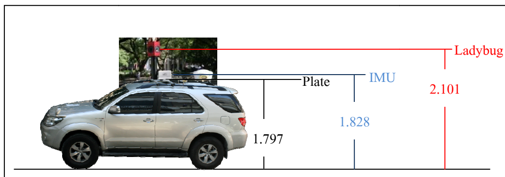
ภาพที่ 4-11 ความสูงของอุปกรณ์บนยานพาหนะเทียบกับพื้น
