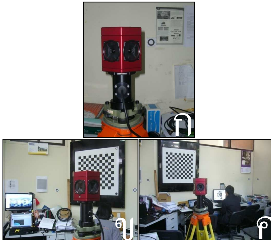
ภาพที่ 3-3 การตั้งกล้องถ่ายภาพพานอรามาให้อยู่ในแนวตั้ง สำหรับการทดสอบ
