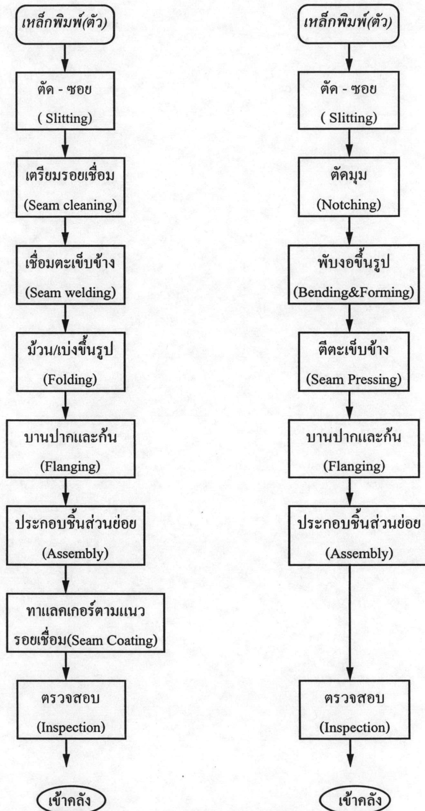
รูปที่ 3.4 ขั้นตอนการผลิตกระป๋องชนิดเชื่อมตะเข็บและชนิดตีตะเข็บ
