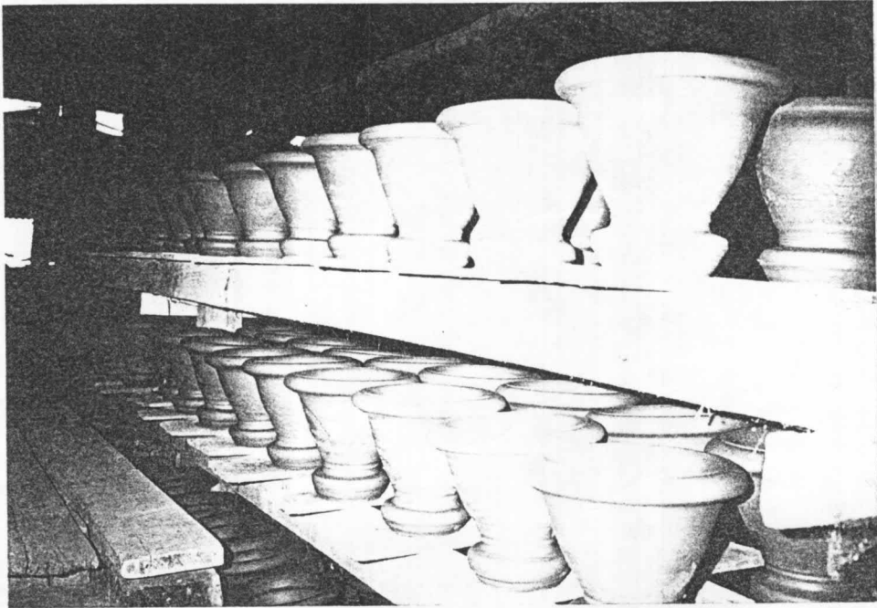
ภาพที่ 18 ภาพการตั้งครกในที่รมก่อนที่จะนำไปเข้าเตาเผา
