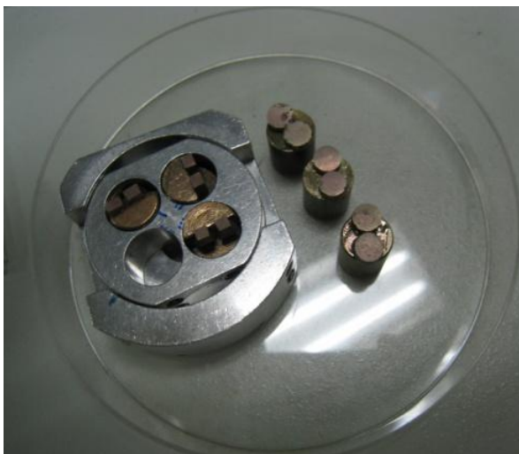
รูปที่ 17 แสดงชิ้นทดสอบที่แตกหักและนำไปติดบนแท่นทองเหลือง
