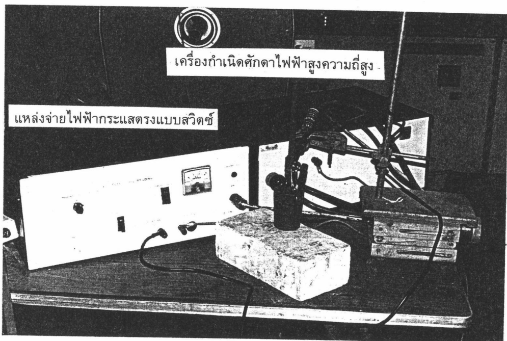
รูปที่ 3.14 ภาพถ่ายเครื่องไมโครอาร์คพลาสมาที่พัฒนาขึ้น
