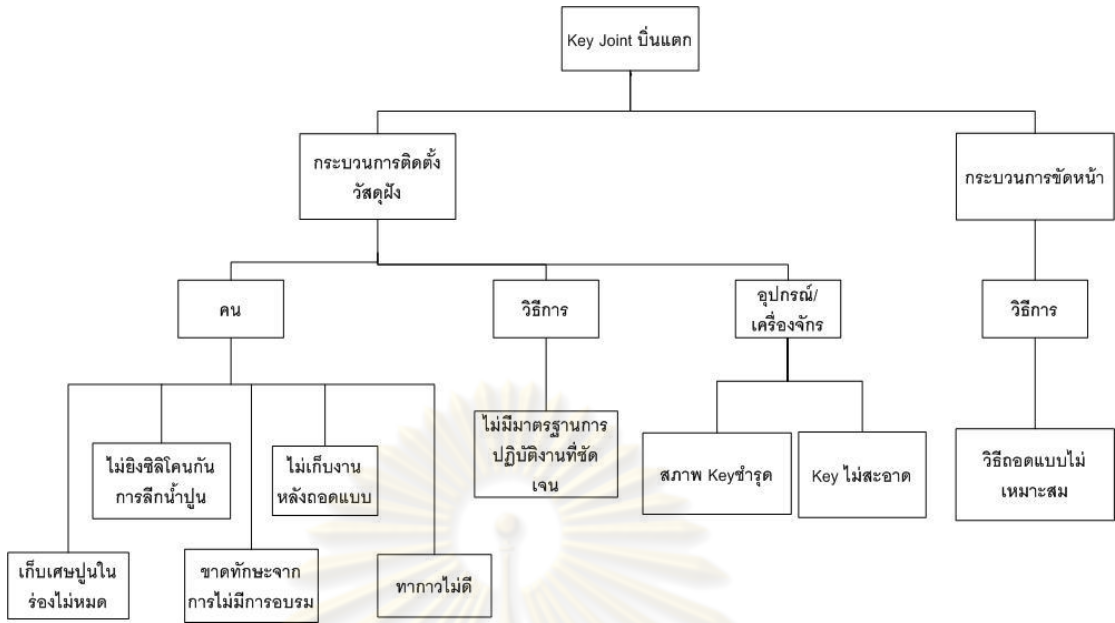
รูปที่ 5.27 สรุปสาเหตุหลักของข้อบกพร่อง Key Joint บิ่นแตก
