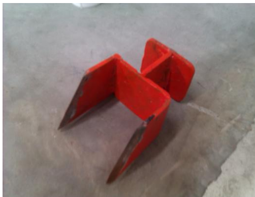
รูปที่ 6.18 อุปกรณ์สำหรับถอด Key
