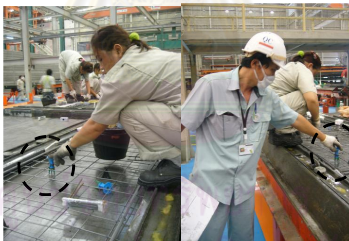
รูปที่ 6.11 การตรวจสอบโดยลองขยับหลังติดตั้งวัสดุฝังโดยพนักงานผลิตและช่างเทคนิค
