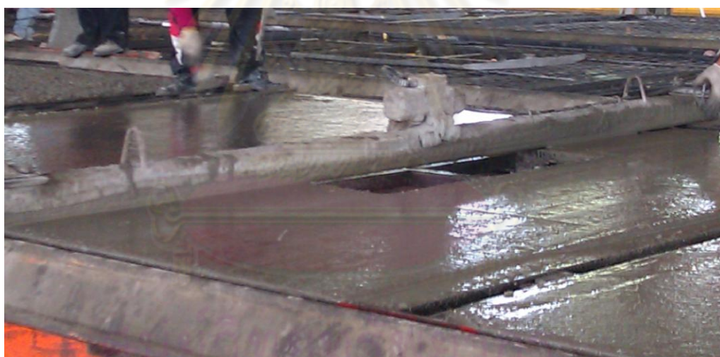
รูปที่ ข.4 การสั่นคอนกรีตของโรงงานที่ผลิตรูปแบบอยู่กับที่
