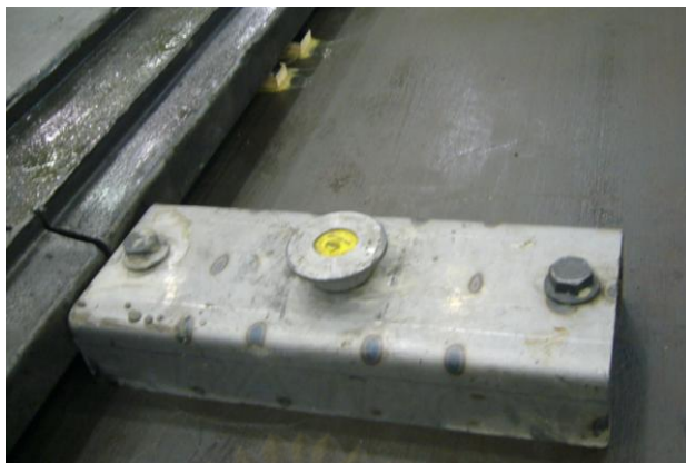
รูปที่ 6.2 แม่เหล็กชนิดใหม่ที่รับแรงได้มากกว่าแม่เหล็กแบบเก่า
