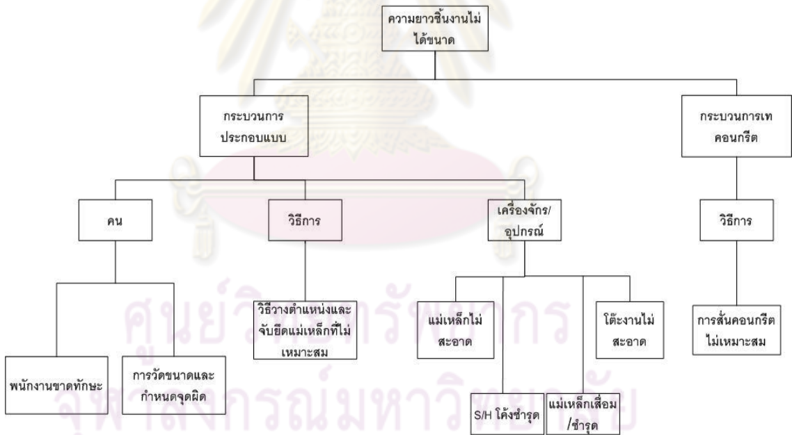
รูปที่ 5.26 สรุปสาเหตุหลักของข้อบกพร่องความยาวขึ้นงานไม่ได้ขนาด
