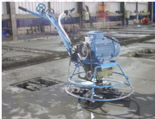
รูปที่ 3.10 เครื่องขัดผิวหน้าผนังคอนกรีตสำเร็จรูป
