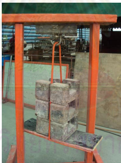
รูปที่ 6.1 การทดสอบแรงแม่เหล็กเก่าของโรงงาน
