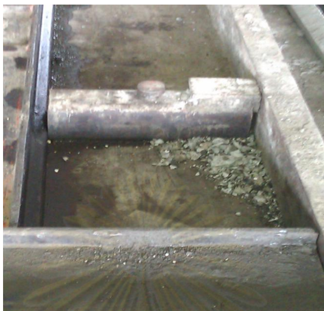
รูปที่ ข.1 ไตะงานและใต้แม่เหล็กที่ไม่สะอาด
