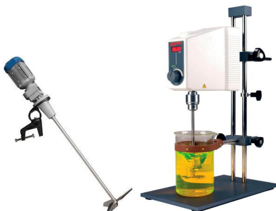
ภาพที่ 4.2 : อุปกรณ์ที่ใช้ในการปั่นกวน
