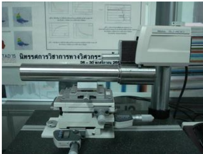
รูปที่ 3.12 การวัดความขรุขระชิ้นงาน
