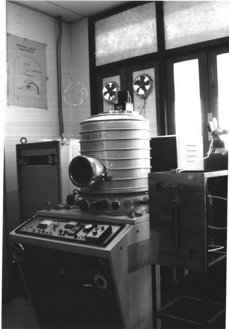
รูปที่ 3.8 เครื่องระเหยโลหะแบบลำอิเล็กตรอน
