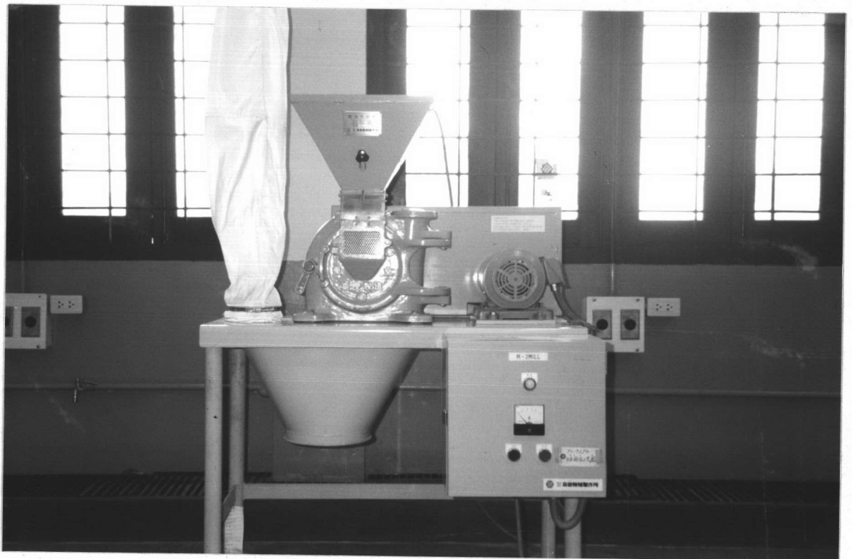
รูปที่ 4.4 เครื่องลดขนาดอนุภาค ( บดย่อย ) ชนิด Pulverizer รุ่น JIYA MPV-2
