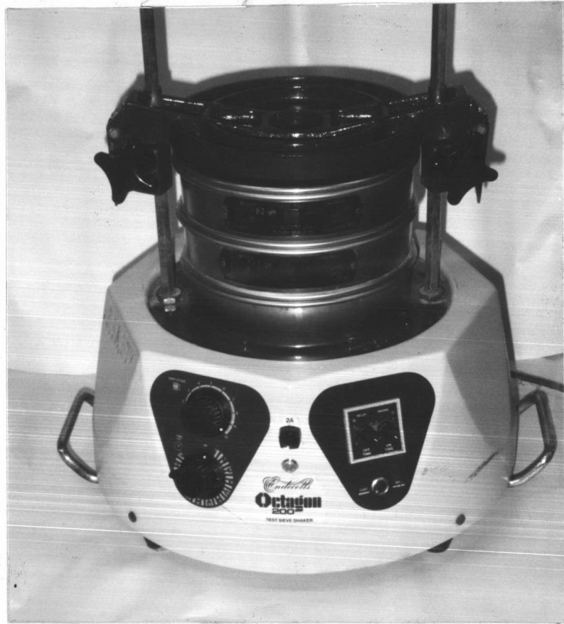
รูปที่ 4.5 แสดงเครื่อง Test Sieve Shake รุ่น Octagon 200 และ Laboratory Test Sieve ขนาด 70-80 mesh ซึ่งใช้ในการคัดขนาด
