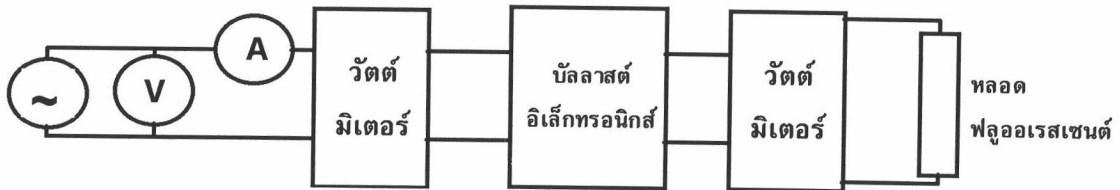
รูปที่ 4.1 ไดอะแกรมการต่อเครื่องมือวัดทดสอบบัลลาสต์อิเล็กทรอนิกส์
