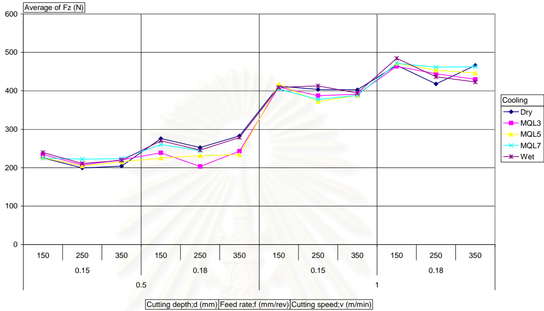
รูปที่ 4.49 กราฟระหว่าง Fz กับปัจจัยต่างๆ ตามความเร็วตัด
