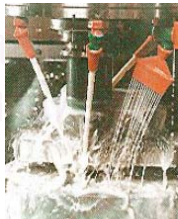
รูปที่ 2.16 การใช้สารหล่อเย็นแบบดั้งเดิม หรือการหล่อเย็นแบบเปียก [3]
