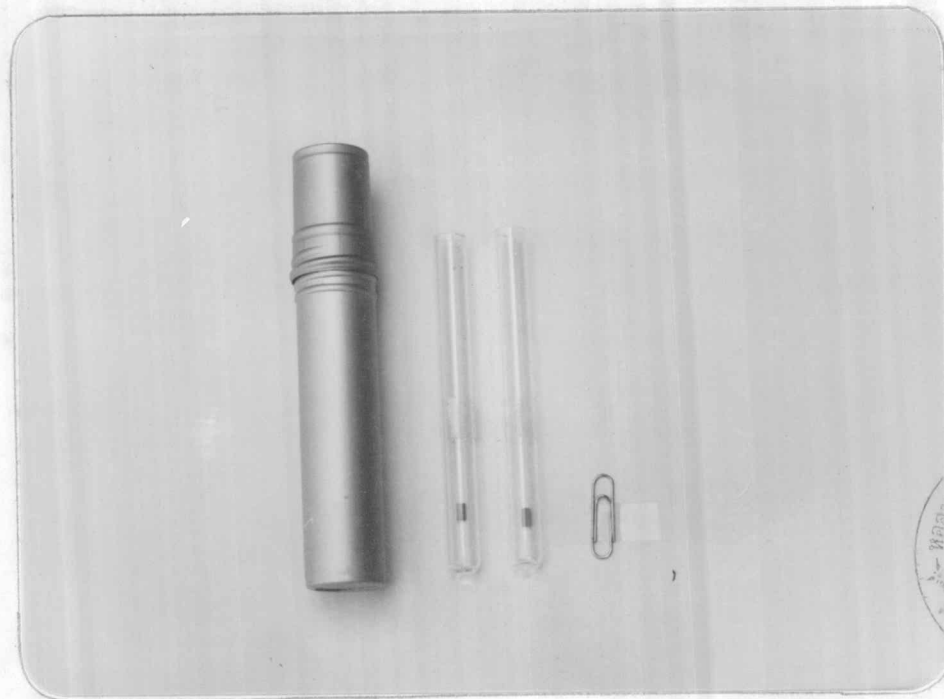
รูปที่ 4.6 แสดงให้เห็นชิ้นของดีรยนต์ของกลางที่เป็นค็ที่อยู่ในหลอดแก้วชนิดควอทซ์ เพื่อบรรจุในระบบออดูมิเนียมเพื่ออาบรังสีใน Lazy Susan เปรียบเทียบขนาดกับคลิป์หนีบกระดาษชนิดมาตรฐาน
