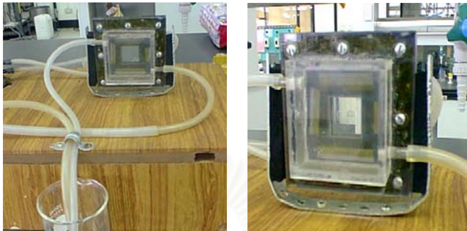
รูปที่ 3.1 ชุดอุปกรณ์ที่ใช้ในกระบวนการพอกพูนโลหะโดยไม่ใช้กระแสไฟฟ้า ขนาด 9.5 \times 9.5 เซนติเมตร พื้นที่ในการเกิดปฏิกิริยา 5 ตารางเซนติเมตร
