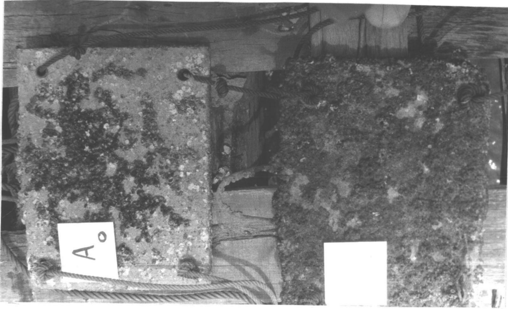
ภาพที่ 11 สภาพของแผ่นปูนแบริวราที่ระกัมป์ของ การโบลเหนือน้ำ 46% และ 68% เมื่อทดลองไว้ 8 เดือน
