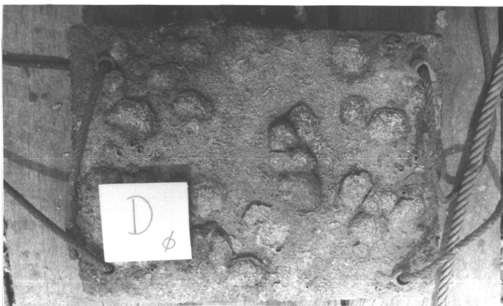
ภาพที่ 13 หอยนางรมที่เกาะบนแผ่นปูนแนวราบที่มีช่วงเวลาไหลเหนือน้ำ 0% เมื่อทดลองได้ 8 เดือน (ขนาดความสูงเฉลี่ย 47.11, ความยาวเฉลี่ย 37.22)
