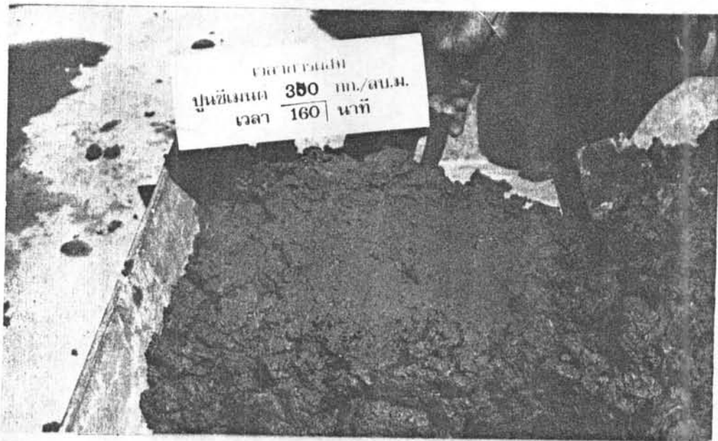
รูปที่ 3.5(ค) แสดงการยุบและสภาพของคอนกรีตส่วนผสมที่ 2 ที่เวลาการผสม 160 นาที จากการทดลองเพื่อศึกษาอิทธิพลของเวลาการผสม
